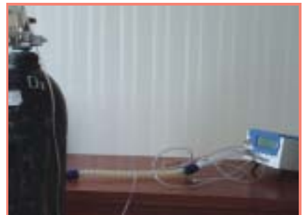
矽質呼吸管空氣阻抗測試
